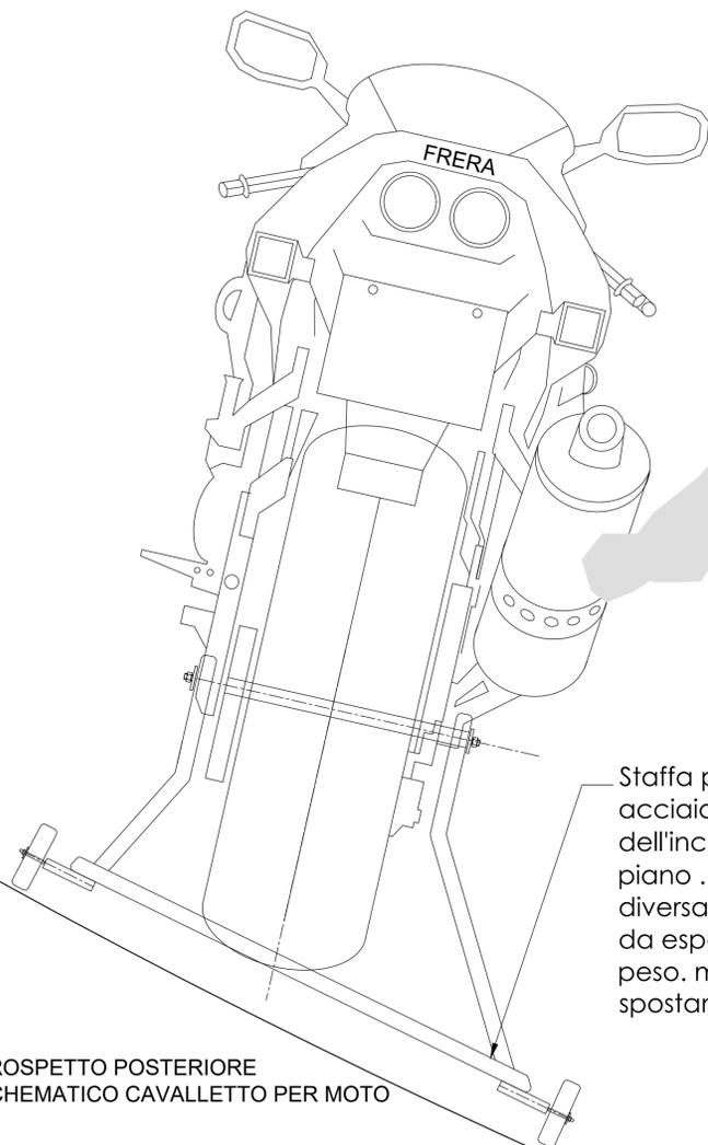
Staffa per sostenere la moto realizzata in tubo di acciaio da 38 mm sagomato a seconda dell'inclinazione della pedana, può essere anche in piano. Sarà cura dell'appaltatore prevedere una diversa configurazione a seconda della motocicletta da esporre, valutando l'altezza, l'inclinazione, ed il peso. munita eventualmnte di ruote per facilitare lo spostamento
